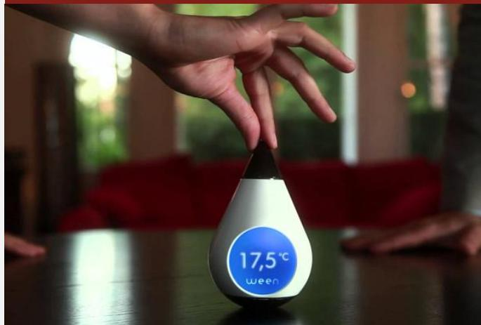
Ween est un thermostat connecté qui adapte la température de son intérieur en temps réel et en fonction des déplacements des habitants. Dès que l'utilisateur quitte sa maison, Ween le détecte et réduit la température pour faire des économies. Alors que la plupart des thermostats sont fixés au mur, Ween est en plus un réel objet design qui s'intègre à tous les intérieurs.
